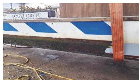
Unter der Antifouling-Schicht hatte sich Osmose gebildet. Dies muss Zeitnah entfernt werden.
