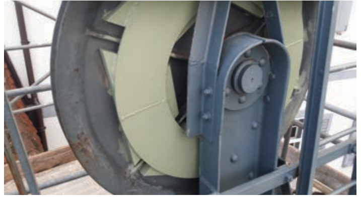
Die reparierte Umlenkrolle der Klingentalfähre an der Spitze des Mastes auf der Grossbasler Seite.
