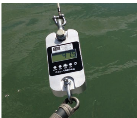
Elektronische Federwaage beim Messen der Gierseilkräfte.
