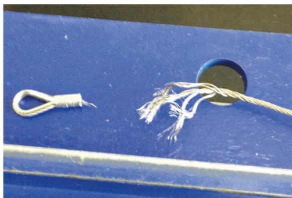
Am 19.03.2013 fand bei der Brugg Drahtseil AG der Belastungstest für die neuen Gierseile statt. Das Foto zeigt die Rissstelle bei einer Belastung von 10.03 kN (zirka 1 Tonne) unmittelbar an der «Anpresskausche» beim Gierseil-Ende.
