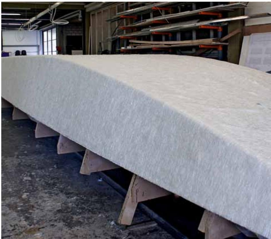
Vorarbeit am Rumpf zur Vorbereitung für das GFK Vakuum-Injektionsverfahren (GFK = Glasfaserverstärkter Kunststoff).
